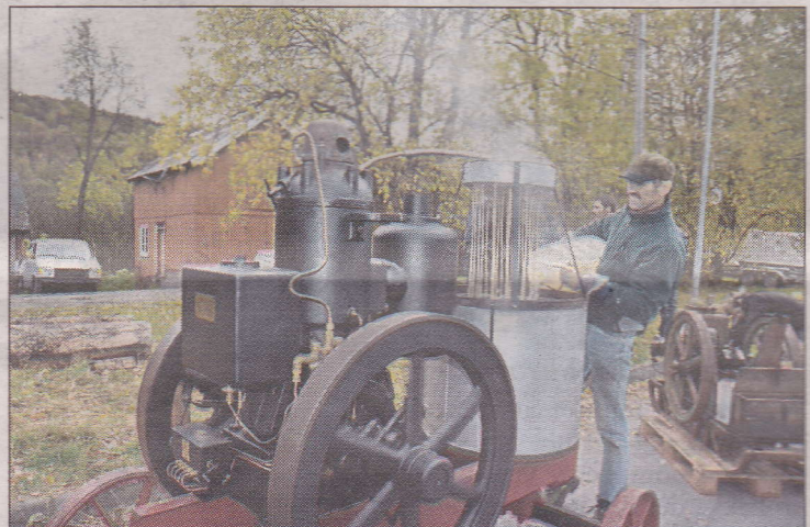
VANNKJØLING: Jostein Staverløkk stilte også ut en gammel dieselmotor. Motoren er vannkjølt, og det må etterfylles vann i den store tanken jevnlig, når motoren går.
