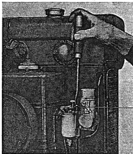
Fig. 14. — Démontage du gicleur principal.
